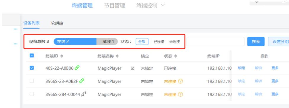
3.1.3 设备列表：展示设备的基本信息，包括终端 ID、终端名称、锁定状态、连接状态、IP 地址、设备分辨率、固件和软件版本等。
